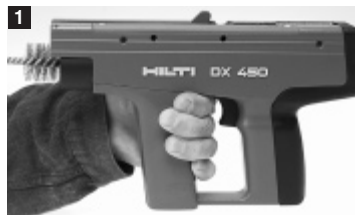
Чистка внутренней части корпуса.
