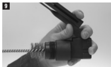
Чистка внутренней части опорной пластины.
