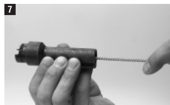
Чистка внутренней части направляющей крепежного элемента..
