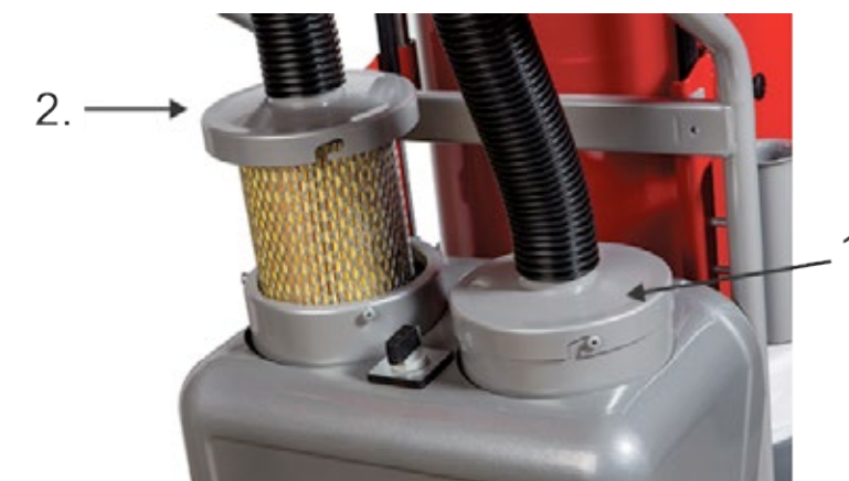
Figur 7 Toppen på HEPA filterhuset på Scan Dust 2900
